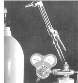
**Configuración típica del soplete de corte**
